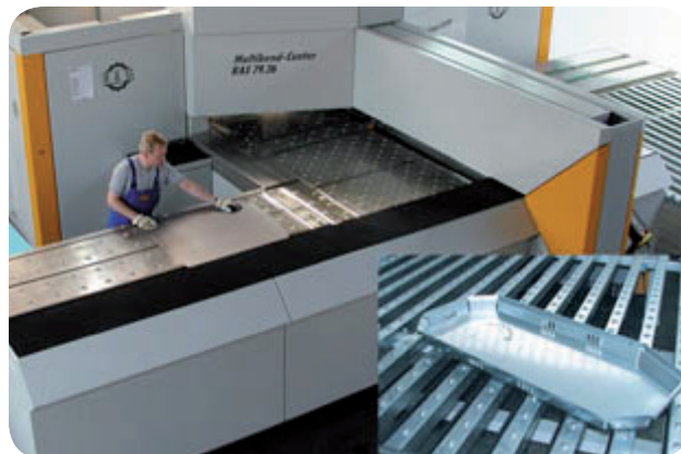
Riemenschutz mit 24 Biegungen in weniger als 3 Minuten erstellt: Das "Multibend Center 79.26" von RAS.
