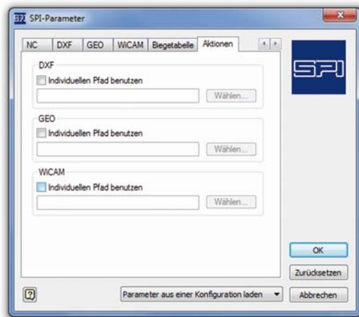
Abb. 6: Jedem Abwicklungsziel kann eine Aktion zugeordnet werden, die nach der Abwicklung automatisch ausgeführt wird.
